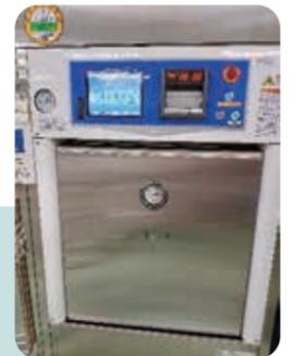
そのため、適切な方法で洗浄を行っています。また、洗浄だけでは交差感染のリスクがありますので、高圧蒸気滅菌(オートクレーブ)を行い、滅菌の状態にしています。安心安全に医療活動ができるように縁の下の力持ちで頑張っています。
